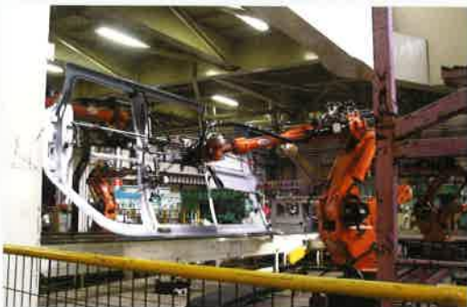
ロボットによる大型パネルパレタイズ Large panel palletizing by robots 基于机械手的随行工作台
