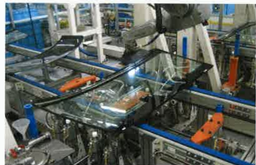
ウィンド接着剤塗布装置 Windshield adhesive spreader 车窗黏合剂涂抹装置
