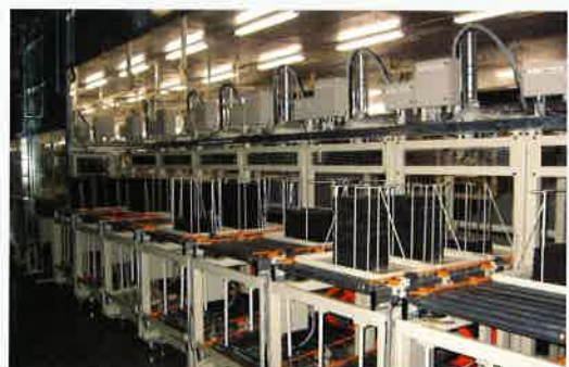
メルシートピッキング装置 Mel-sheet picking machine 地板(隔音)隔热板的拣选装置
