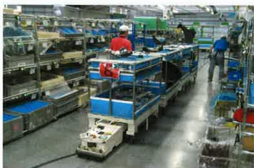
無人搬送による物流サービス Unattended part distribution system 无人搬运的物流服务
